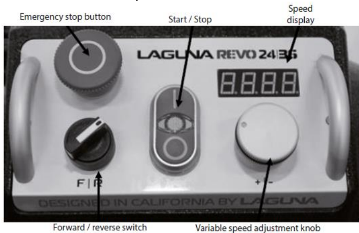
Emergency stop button - Vészleállító Start / stop buttons - Start / Stop Speed display – Fordulatszám kijelző Forward / reverse switch – Forgás irány Variable speed adjustment knob – A fordulatszám fokozatos beállítása
